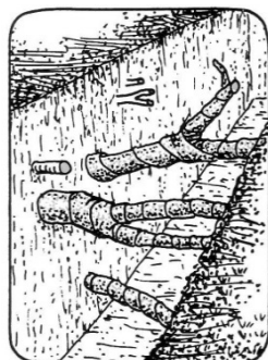
A. zabezpieczenie korzeni B. ekran ochronny
